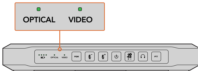
Wird am SDI- oder HDMI-Eingang ein gültiges Videosignal erkannt, leuchtet der VIDEO-Statusindikator des ATEM Camera Converters. Wird am Glasfasereingang ein gültiges SDI-Signal erkannt, leuchtet der OPTICAL-Statusindikator
